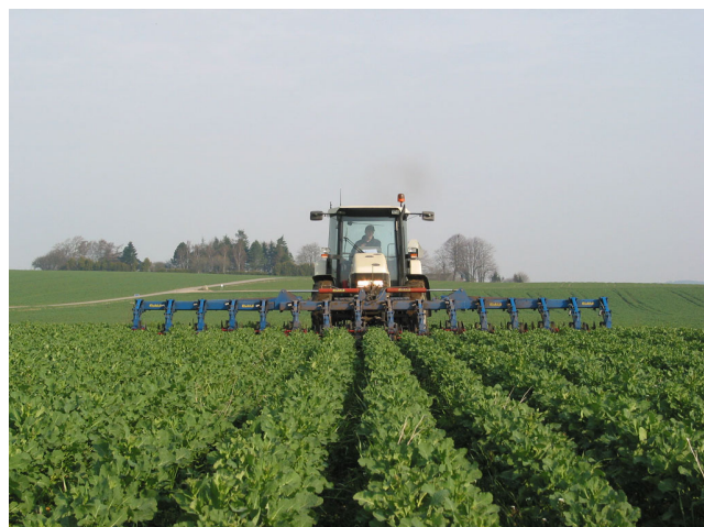
Billede 1. Brede radrenser og kamerastyring betyder, at rækkesåning og radrensning ofte vil være et konkurrencedygtigt alternativ til kemien. Foto: Torkild Birkmose, Videncentret for Landbrug.
